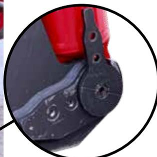
Alinee la placa de bloqueo en la tuerca del cilindro
