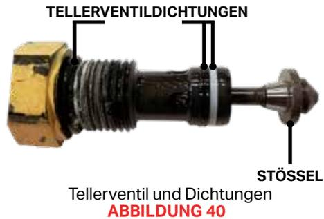
4. Teller Ventil und Stößel auf Beschädigungsfreiheit kontrollieren. Sich vergewissern, dass der Stößel sich frei im Ventil bewegt. Bei festgestellter Beschädigung Teller Ventil und Dichtungen ersetzen (Teilenummer 513793).
